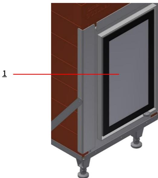
Die Anlage sollte regelmäßig, jedoch mindestens einmal pro Jahr, gereinigt werden. Entfernen Sie rechtzeitig, je nach Intensität der Benutzung die Asche. Dieses ist unbedingt durchzuführen wenn die Aschenhöhe die halbe Höhe zwischen Feuerraumtürunterkante und Feuerraumboden erreicht hat.
