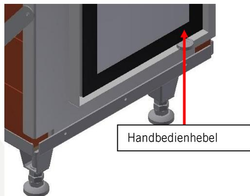
Der Bedienhebel ist in seiner Funktion gekennzeichnet.
